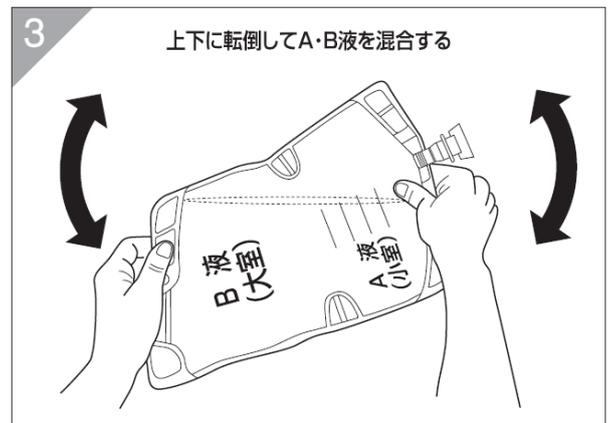
吊り下げ部とポート部を持ち、2～3回上下に転倒させてA・B液を混合して下さい。
